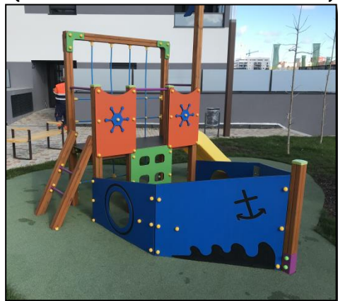
RAMPA DE TOBOGÁN DE ACERO INOXIDABLE PANELES DE POLIETILENO DE ALTA DENSIDAD DE GRAN RESISTENCIA A LA INTEMPERIE)
